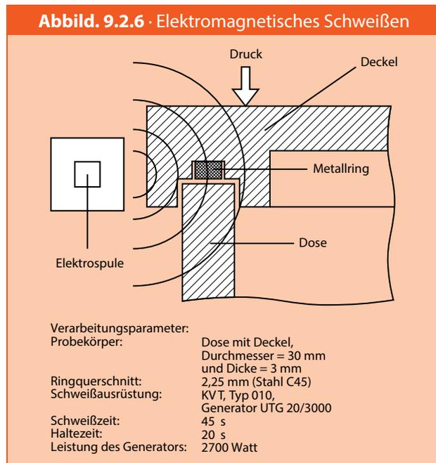
Verarbeitungsbedingungen ab, die gemeinsam mit dem Ausrüstungshersteller festgelegt werden müssen. Aus Effizienzgründen kann die längere Schweißzeit durch die Verwendung eines Multi-Schweiß-Systems kompensiert werden. In Schweißversuchen (vgl. Abbildung 9.2.6) hielten Vectra A130 und Vectra A625 Formteile einer Bruchlast von 1300 – 1650 N stand (vgl. Tabelle 9.2.1).
