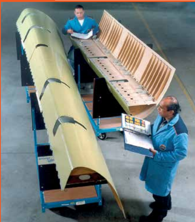
Tragflächenkante des Airbus A340 und A380
