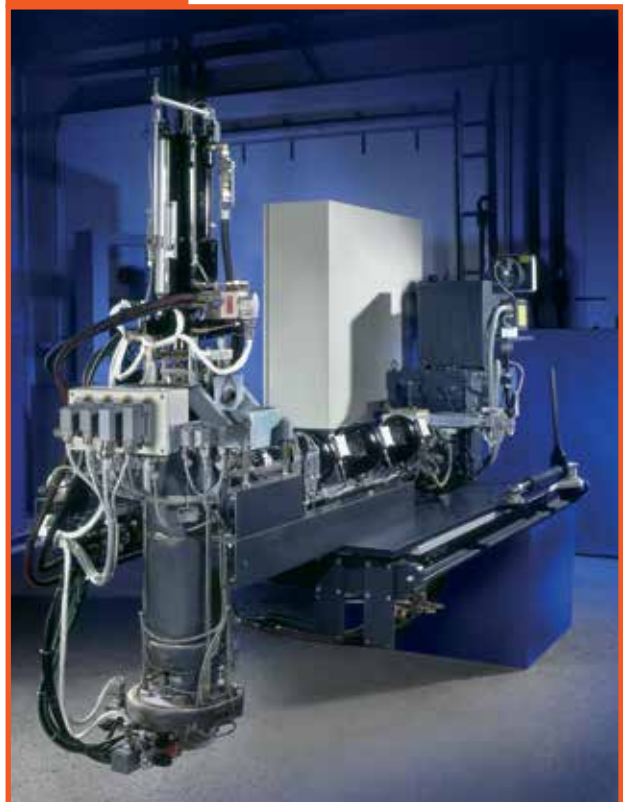
Saugblasformmaschine (Foto SIG-Kautex)
