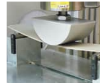
Deformación transversal ISO 13007 Adhesivos ceramicos
