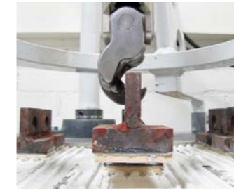
Tensile adhesion strength EN 12004 Tile adhesives
